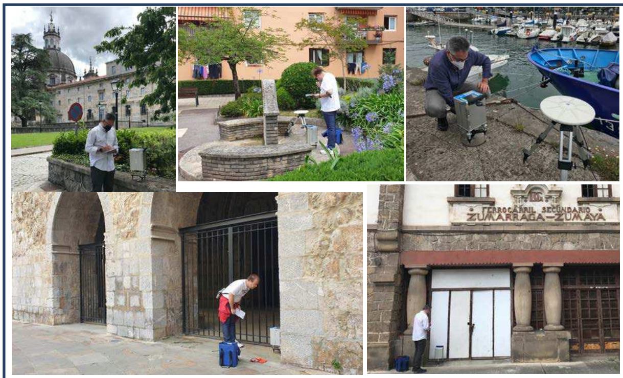
Figura 2. Fotografías tomadas durante la campaña de medida de gravedad (junio-julio 2021) en la red de Guipúzcoa.
